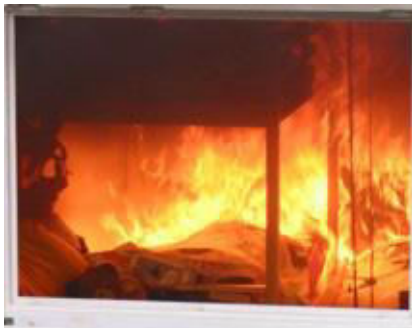
Kinderzimmerbrand nach 3 Minuten:
